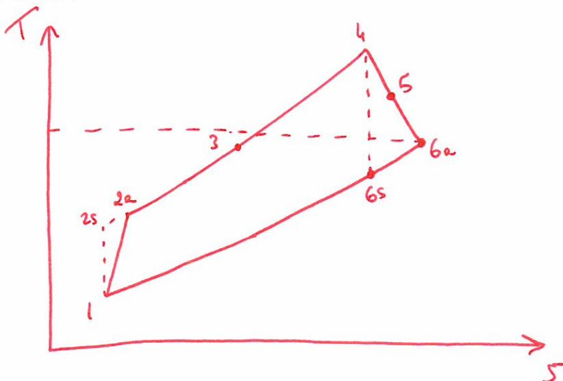
b)  $\frac{h_{2s} - h_1}{h_{2a} - h_1} = 0.8 \Rightarrow h_{2a} = \cancel{0.8} \left( \frac{h_{2s} - h_1}{0.8} \right) + h_1$
